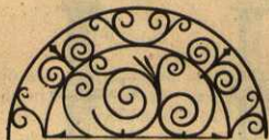
Bandeira de porta em ferro forjado
